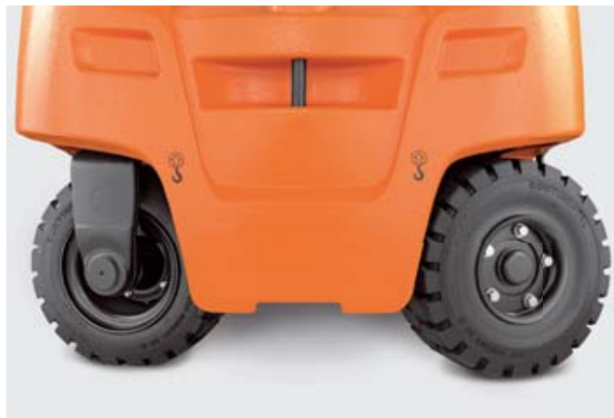
Beide wielen kunnen 90 graden naar links en naar rechts worden gedraaid.
